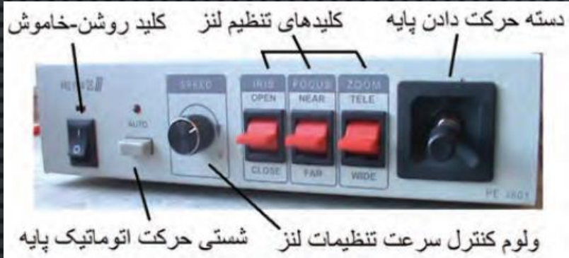
شکل ۳-۵۵ قسمت‌های مختلف جلو کنترل کننده
